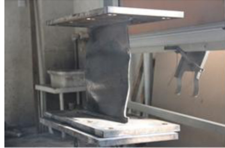
(d) Failure mode for S2
